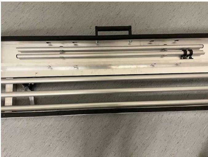
3. Schieben Sie die Längenanschlagsrohre je nach Bahnenbreite in eine der 4 Öffnungen bis ganz nach hinten, und fixieren Sie mit einer Drehbewegung im Uhrzeigersinn (Bajonette)
