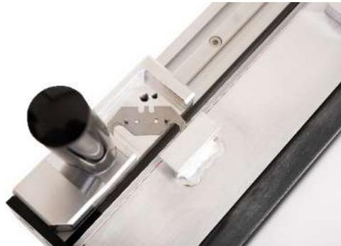
6. Den Gleitschlitten in die Parkposition bringen, wo er durch den eingebauten Haltemagneten im Bereich der Schutzleiste gehalten wird um Schnittverletzungen zu vermeiden.
