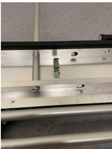
4. Stellen Sie das Gerät nun zurück auf eine ebene Fläche und positionieren Sie auf den beiden Längenanschlagsrohren die mitgelieferten Stellringe in der gewünschten Tiefe anhand der Maßkala. siehe Abbildung
