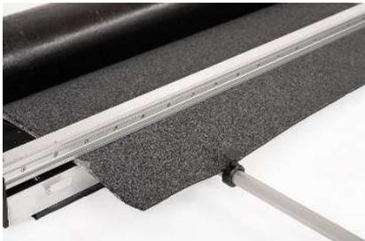
4. Den Gleitschlitten heranziehen und die Bitumenbahn möglichst in einem Zug abschneiden.
